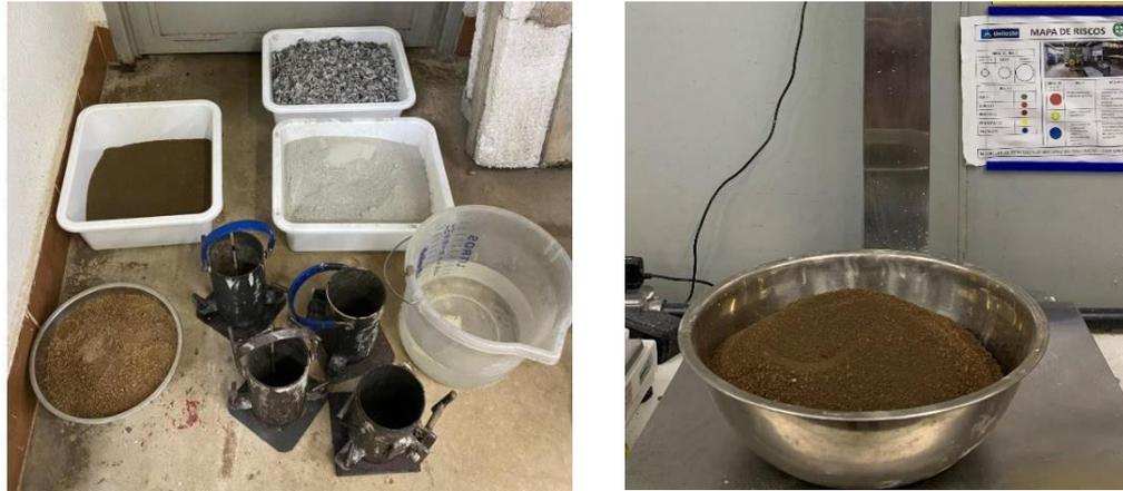
**Figura 1. Materiais utilizados para produção do concreto e resíduo de minério de ferro**
