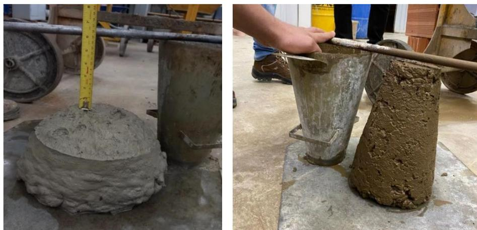
**Figura 2. *Slump test* do concreto padrão e concreto com adição de resíduo, respectivamente**
