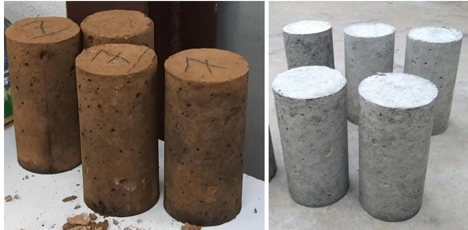
**Figura 5. Corpos de prova com resíduo e sem resíduo, respectivamente**
