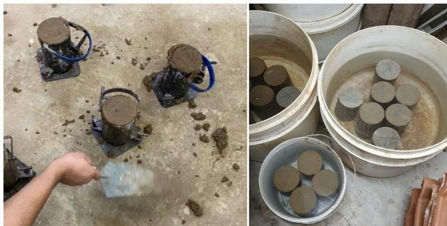
**Figura 3. Moldagem e cura dos corpos de prova**
