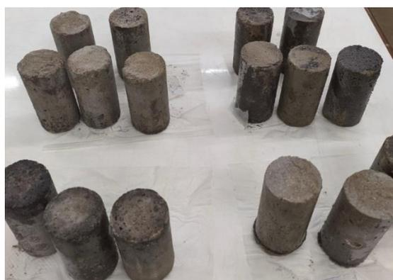
**Figura 5.** Corpos de prova de argamassa desmoldados
