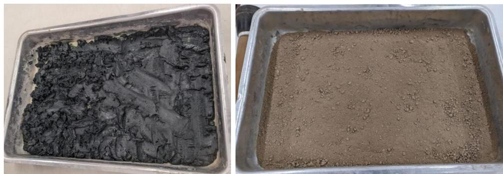
**Figura 3. Aspecto do resíduo *dregs* úmido (a) e após secagem em estufa e moagem manual por pilão (b)**
