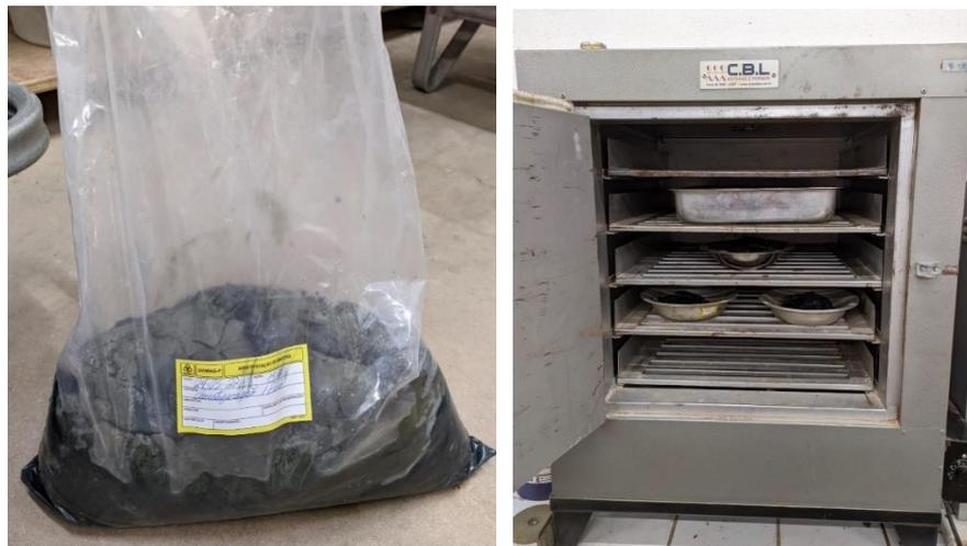
**Figura 2. Resíduo dregs úmido (a) secagem do resíduo em estufa a 105°C (b)**
