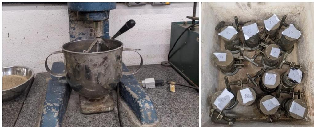
**Figura 4.** Misturador e argamassa dentro dos moldes
