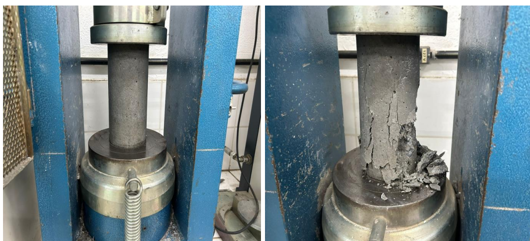
Figura 7. Corpo de prova antes e depois do rompimento, respectivamente Fonte: Autores (2023)
