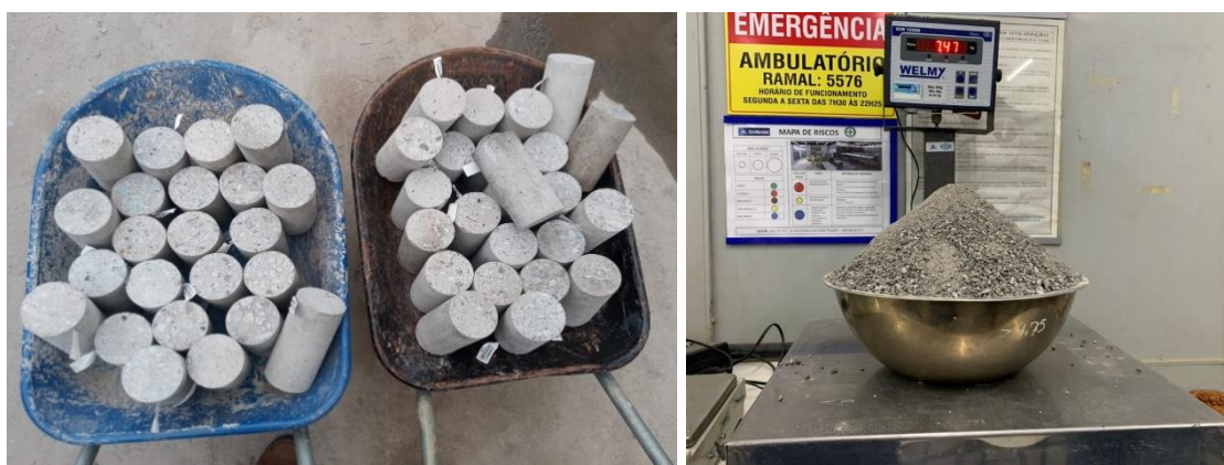
Figura 3: Corpos de prova retirados da concreteira (a) e agregado feito com RCP (b)
