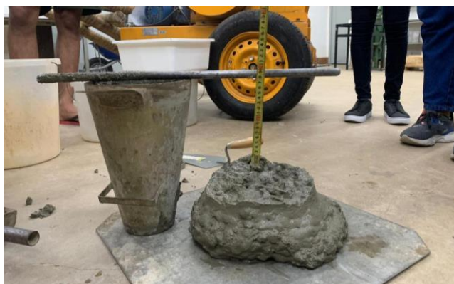
Figura 4. Ensaio de abatimento do concreto sem resíduo
