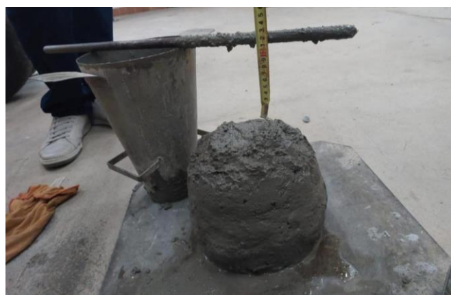
Figura 5. Ensaio de abatimento do concreto com 70% de resíduo
