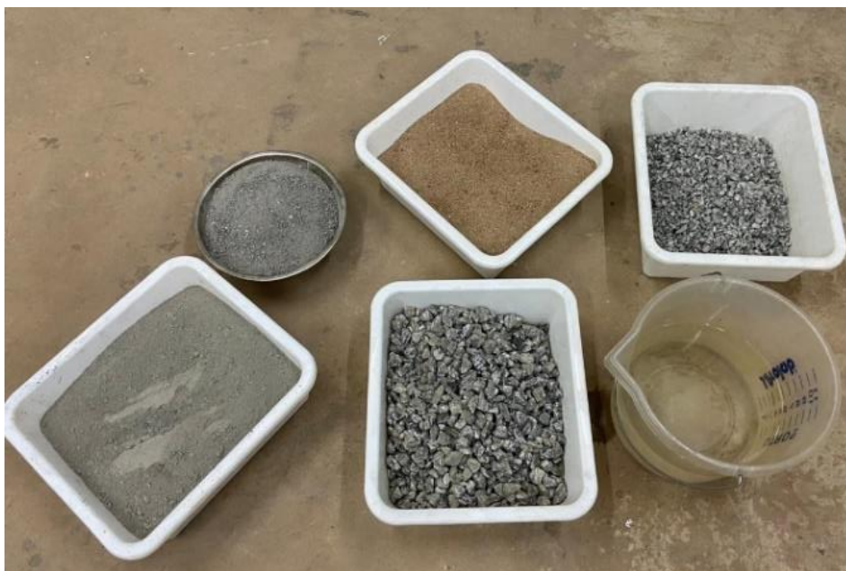
Figura 2: Materiais utilizados na produção do concreto
