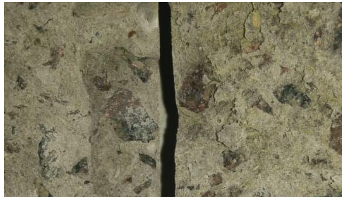
Foto 10. À esquerda, corpo de prova de referência e à direita, corpo de prova reforçado com fibras, ambos rompidos por compressão diametral aos 14 dias.
