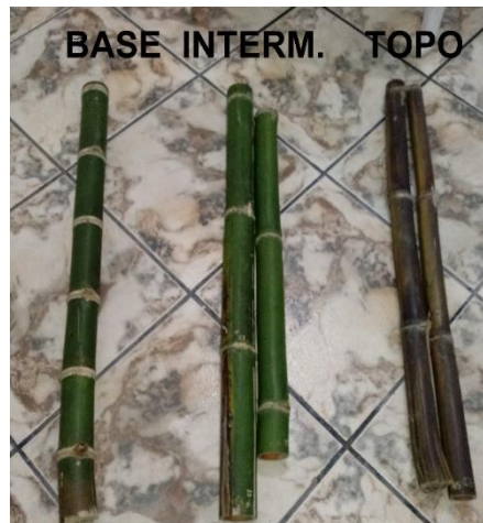
Foto 2. Fragmentos de colmos de trecho basal, intermediário e topo.
