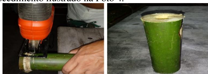
Foto 4. A) Remoção dos nós com auxílio de motosserra B) Internó de bambu Guadua Angustifolia .
