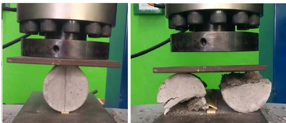
Foto 8 – Ensaio de compressão diametral para determinação de tração.
