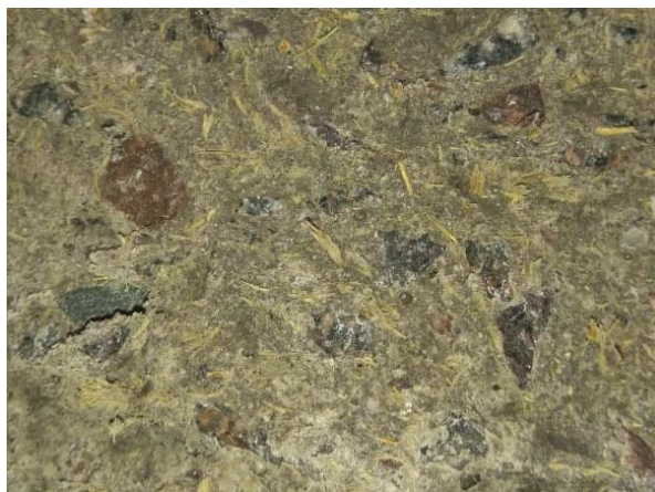
Foto 9. Corpo de prova reforçado (4% de fibras) rompido aos 14 dias (autor).
