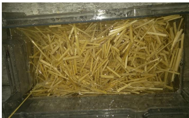
Foto 5 – Cavacos de bambu Guadua Angustifolia imersos em água.
