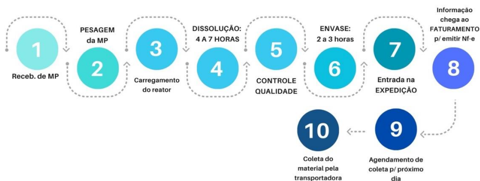
Figura 3. Fluxograma do processo produtivo Fonte: Empresa GAMA (2023)
