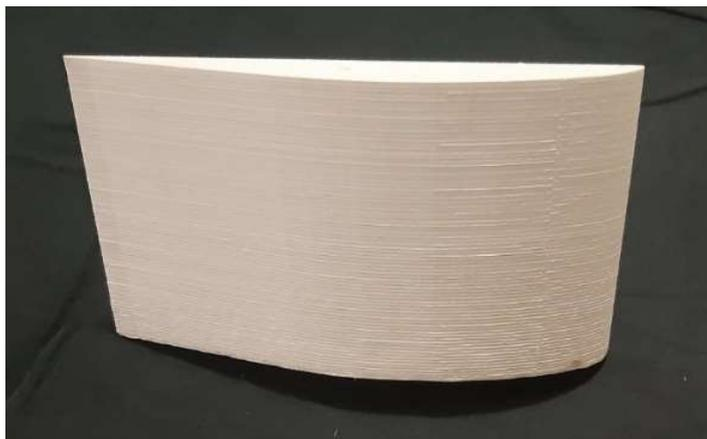
Figura 10. Fase 3, fabricação do protótipo 2 com filamento PLA-LW
