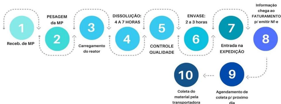
**Figura 3.** Fluxograma do processo produtivo
