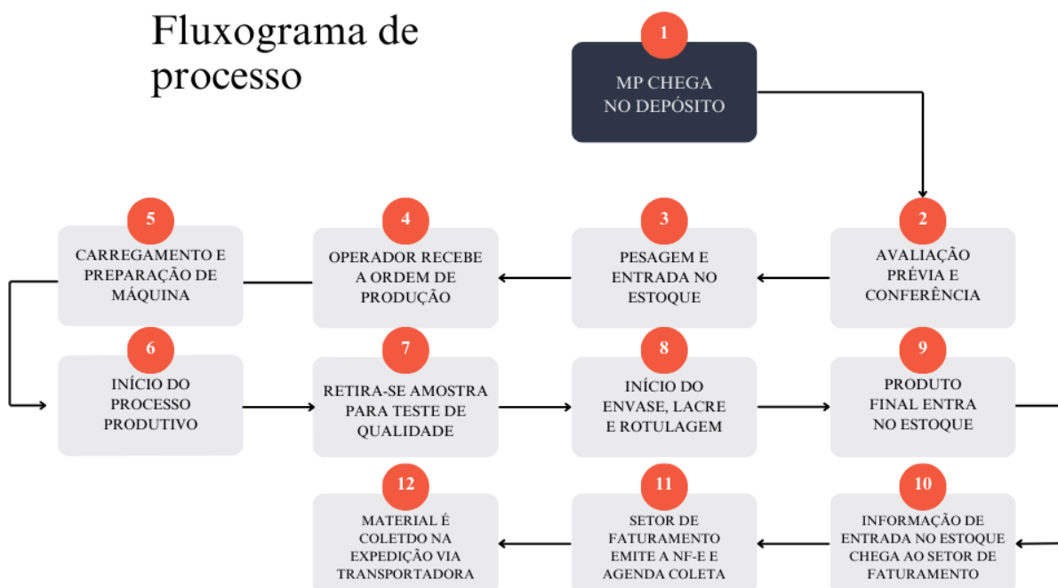
Figura 2. Fluxograma de processo conforme E1
