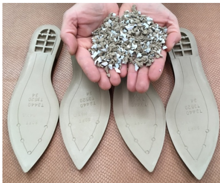
Figura 11. PVC Micro no formato de Pellets e sola injetada no material
