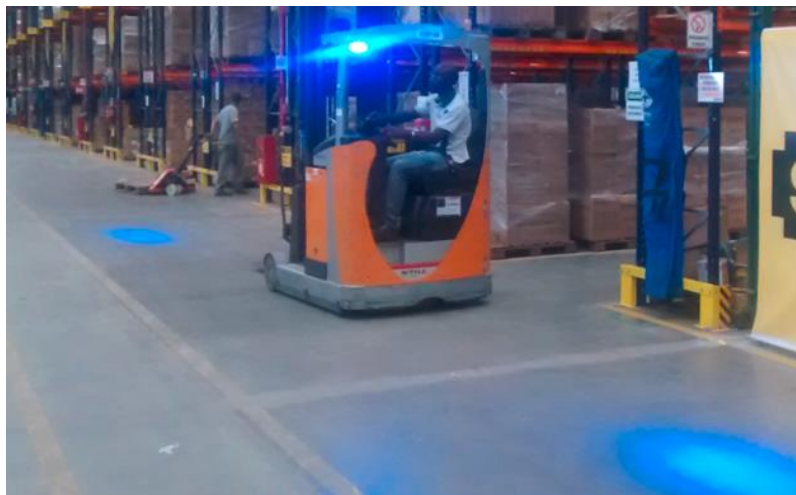
Figura 07 - Dia D - instalação da luz azul, segurança de pedestres.
