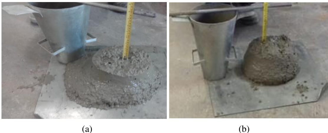
Figura 3. Slump test das amostras de concreto, (a) sem adição fibras, (b) com adição de fibras de borracha.
